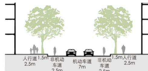
► 湖畔支路断面规划示意图（规划红线宽度 12 米）
