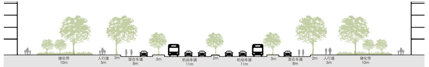
► 主干路断面规划示意图（规划红线宽度 45 米）
