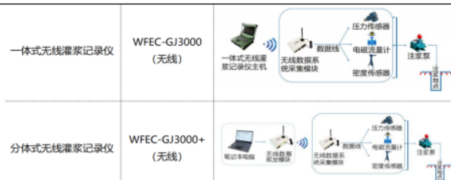
图 2-30 无线灌浆仪型号及传输流程图
