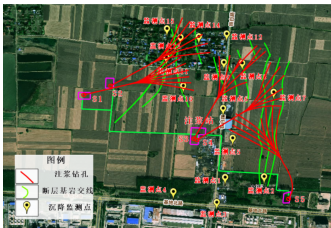
图 2-33 地面变形监测点布置
