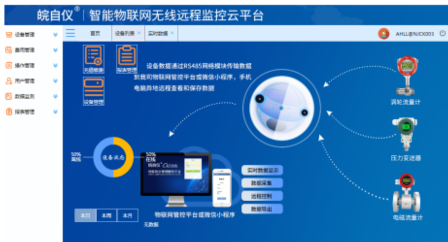
图 2-32 三参数在线检测系统用户云平台
