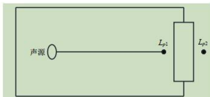
图 4.1 室内声源等效为室外声源图例
