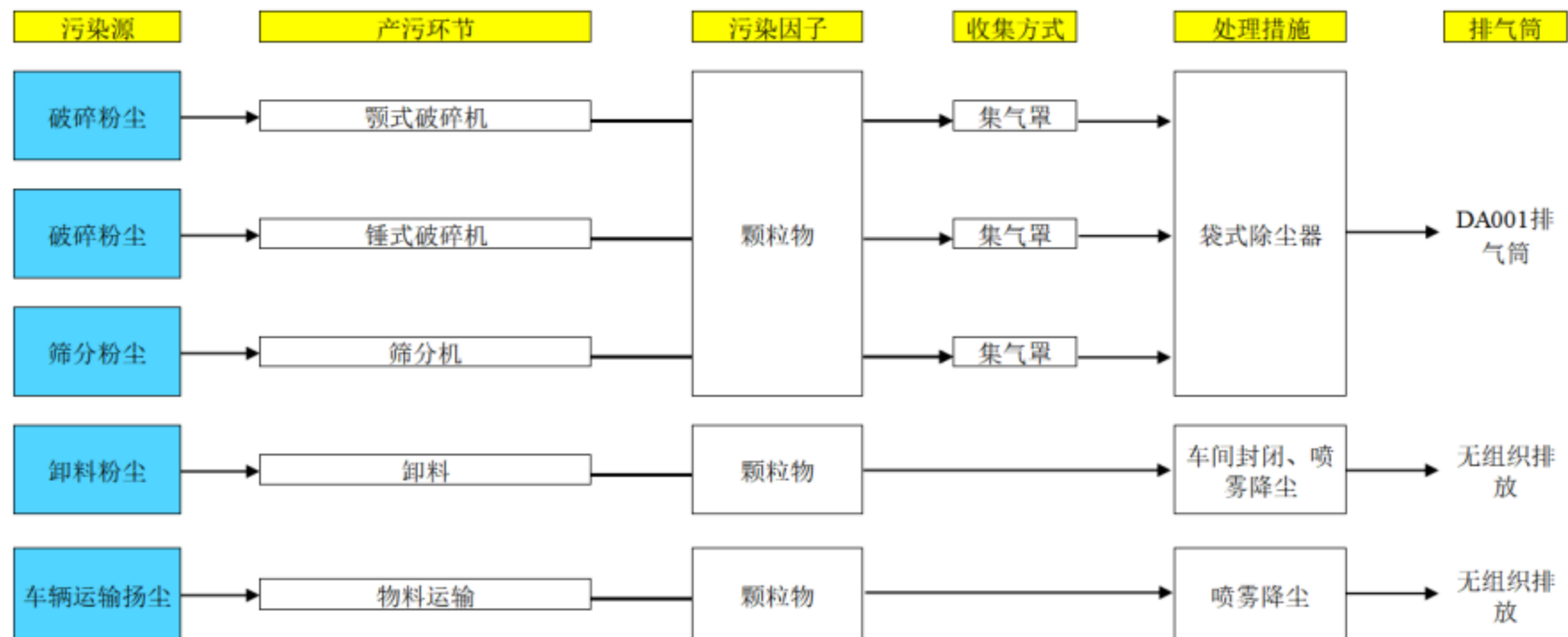
图 4-1 废气收集管线示意图
